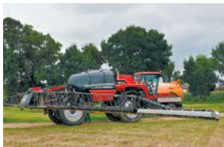
Nový samostatný postrekovač Horsch Leeb s pracovným záberom ramien 36 metrov. Na stroji dokáže obsluha nastaviť svetlú výšku až do 2,1 metra a taktiež rozchod kolies.
