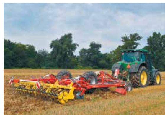
Radličkový kyprič Pöttinger Terria s pracovným záberom štyri metre. Ide o prvý stroj tohto typu dodaný na Slovensko.
