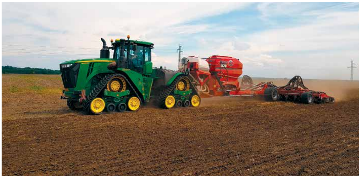
Supervýkonný šesťstotoňový pásový traktor JD 9620 RX utiahne bez problémov sejačku SUMO, ktorá na jeden prejazd pôdu skypri, zapraví do nej semeno, výživu a uzavrie pôdu. Bola vyrobená pre Poľno Sme na mieru.
