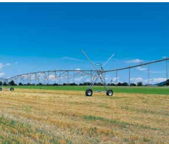
Rekonštrukcia závlah – nový centerpivot v Oponiciach.
