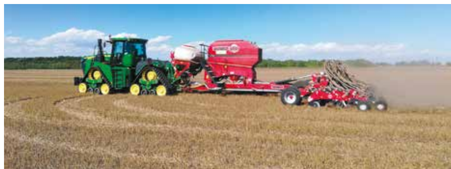
Šesťstokoňový pásový traktor potiahne sejačku, ktorá na jeden prejazd pôdu skypri, zapraví do nej semeno, výživu a uzavrie pôdu.
