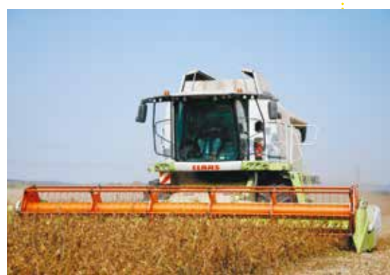
Špeciálne lišty znižujú straty pri zbere sóje. Túto plodinu mali vo firme na 280 ha, z ktorých pozberali v priemere po 3,5 t/ha.
