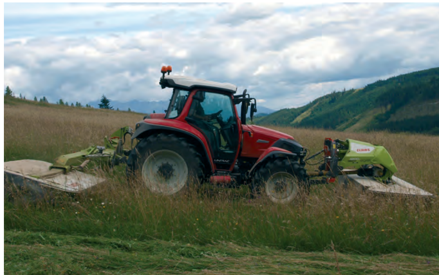
Nový traktor LINTRACK s dvoma kosami zvládne aj 35-stupňový svah.
